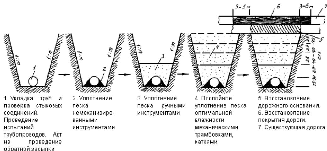
Рис. 2. Последовательность работ по восстановлению дорожной конструкции
