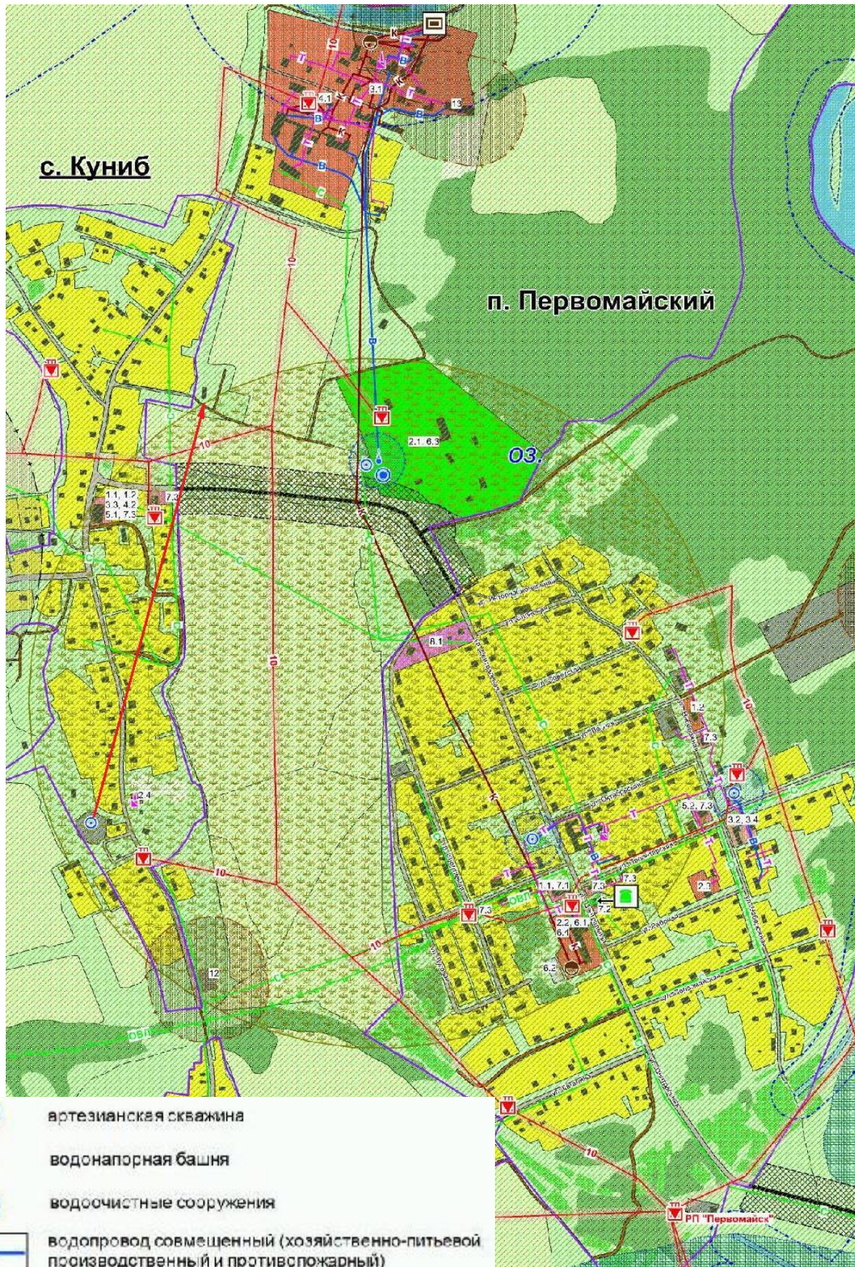
Рисунок 1. Схема водоснабжения населенного пункта при заборе воды из подземных источников (фрагмент из генерального плана, скважина № 1535-Э обозначена стрелкой)
