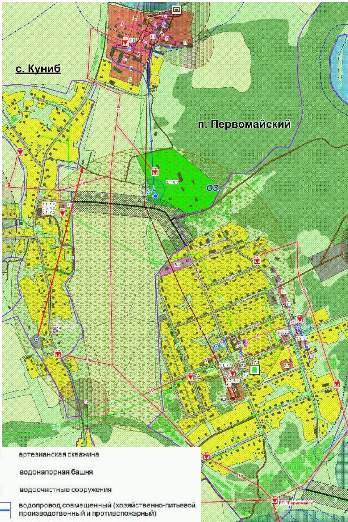
Рисунок 1. Схема водоснабжения населенного пункта при заборе воды из подземных источников (фрагмент из генерального плана,
